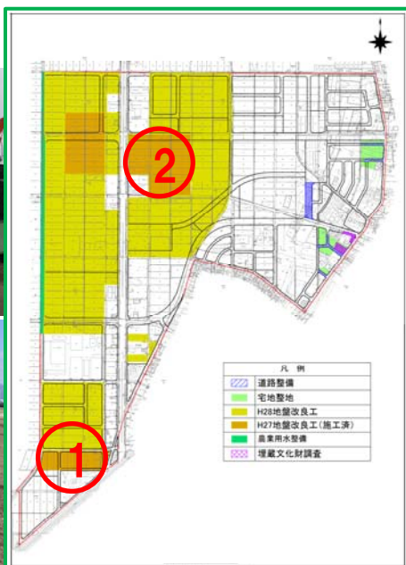
ペーパードレーン工法により沈下促進をしています
